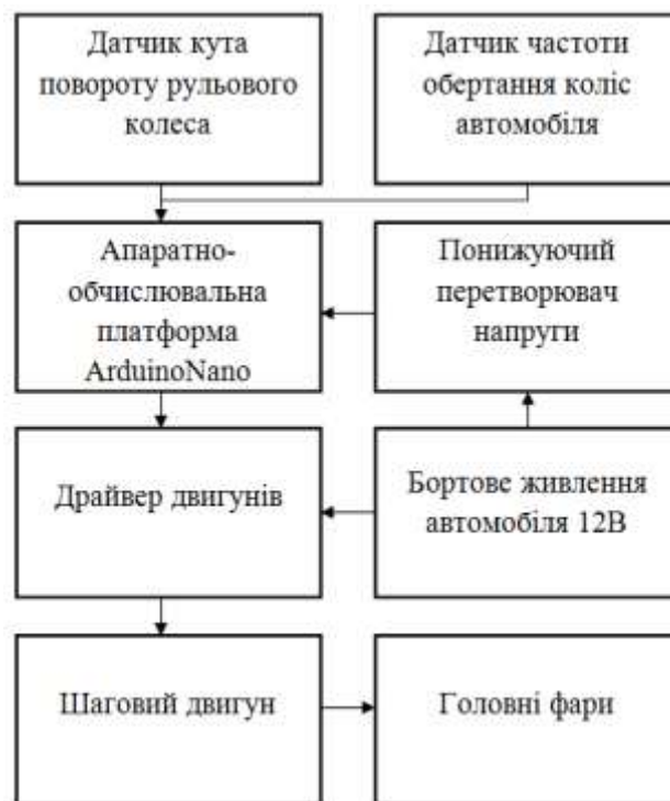
Рис. 6. Структурна схема системи керування головним освітлення автомобіля
