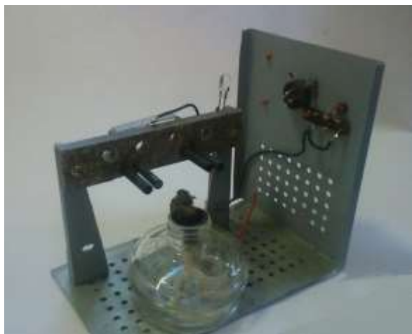
Рис. 5. Макет полум'яно-іонізаційний детектору
