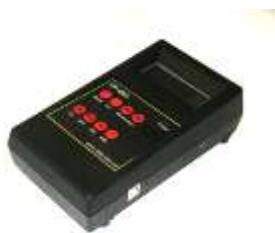
Рис. 2. Спеціалізований відео процесор для рентгенотелевізійних систем неруйнівного контролю якості виробів
