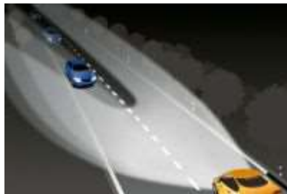
Рис. 4. Режим дальнього світла при вертикальному світлотіньовому кордоні із застосуванням відеокамери
