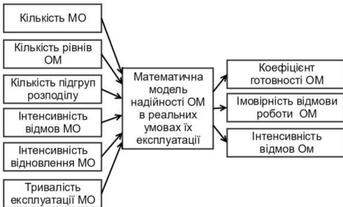
Рис. 1. Система входних та вихідних параметрів математичної моделі локальної обчислювальної мережі
