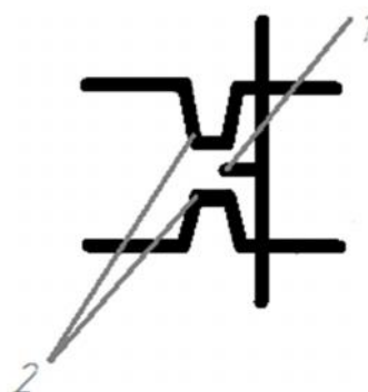
Рис. 2. Структура розрядника з додатковим електродом
