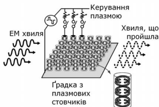
Рис. 8. Плазмові конфігурації, на основі яких можуть бути створені плазмові метаструктури [1]
