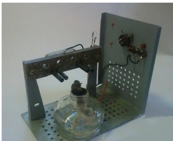
Рис. 5. Макет полум'яно-іонізаційний детектору.
