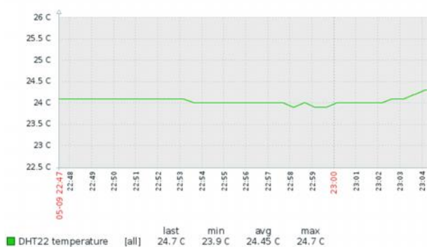
Рис. 2. Графік температури цифрового датчика температури підключеного до Arduino nano у веб-інтерфейсі zabbix
