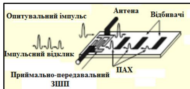
Рис. 3. Транспондер на відбивачах
