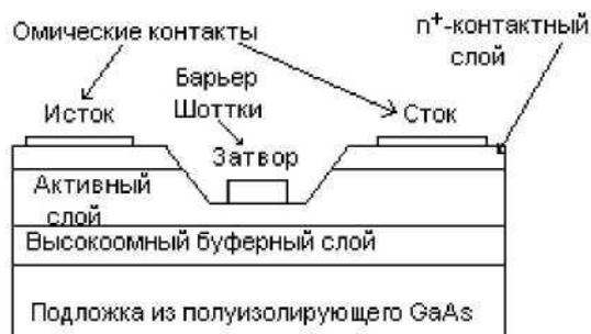
Рисунок 1 - Схематическое изображение GaAs ПТШ с утопленным затвором
