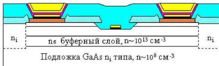
Рисунок 5. - Готовый запассивированный транзистор. В таблице представлены экспериментальные исследования ПТШ.
