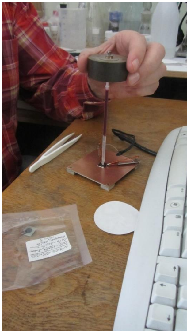
Рис. 2. Процес прикладення тиску на плівку для перевірки наявності п'єзоефекту.
