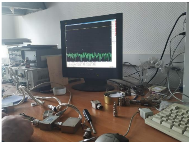
Рис 2. Вимірювання за допомогою приладу «ОБЗОР-103».
