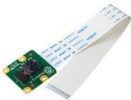
Рис. 2. Модуль камери Raspberry Pi
