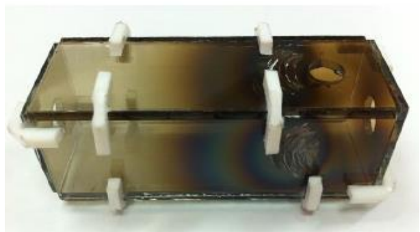
Рис. 7. Підкладка з нанесеним вуглецевим покриттям.
