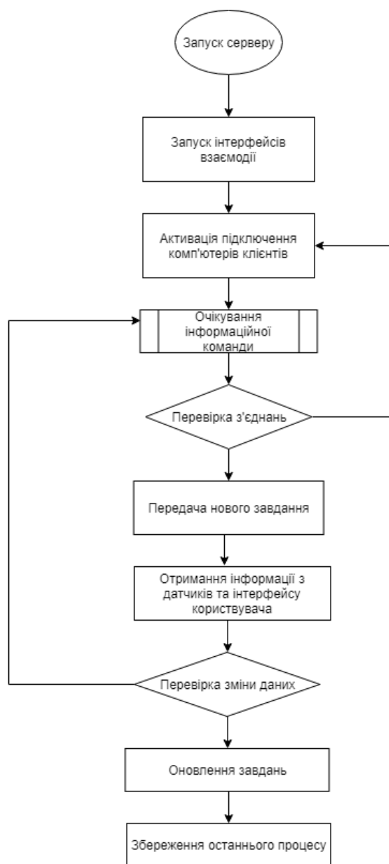
Рис. 3. Схема алгоритму роботи автоматичної системи керування освітленням
