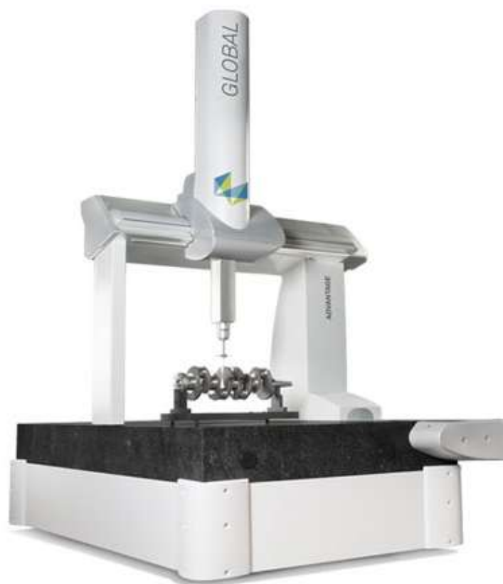
Рис. 1. Зовнішній вигляд 3D сканера GLOBAL Advantage
