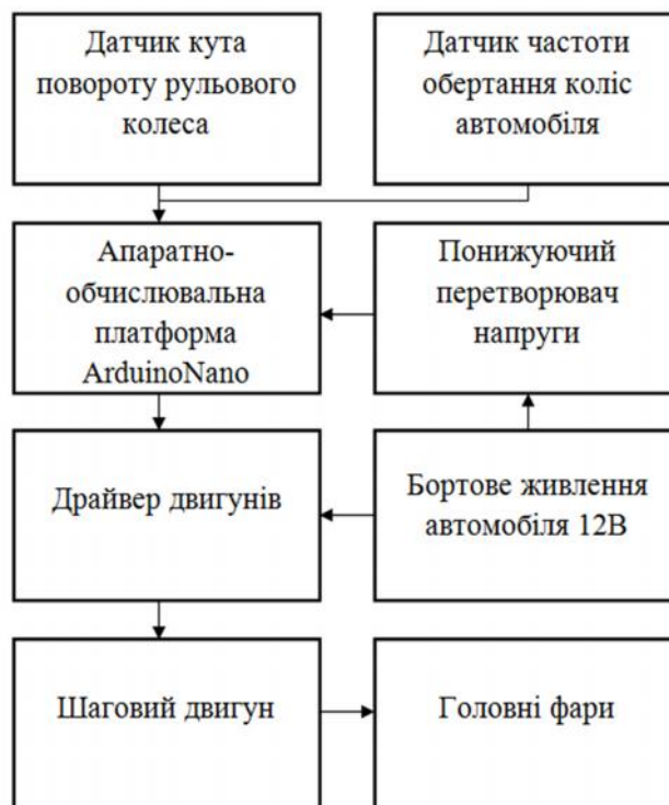
Рис. 6. Структурна схема системи керування головного освітлення автомобіля
