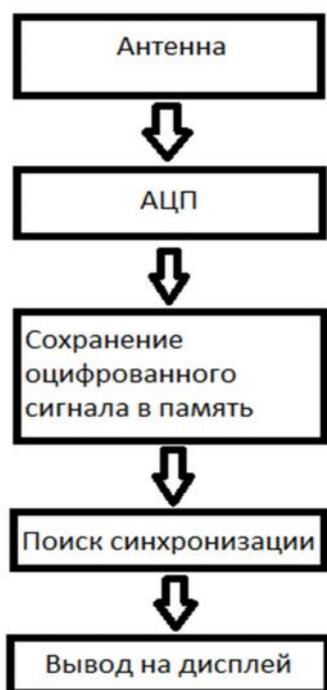
Рис. 1. Структурная схема алгоритма работы прибора
