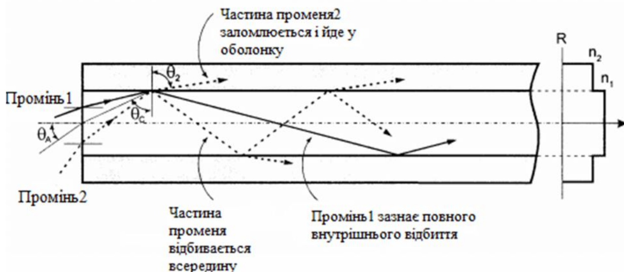
Рис. 1. Поширення світла у волоконному світловоді
