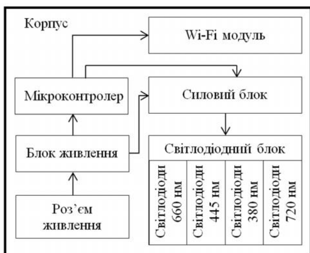
Рис. 3. Функціональна схема пристрою системи освітлення.
