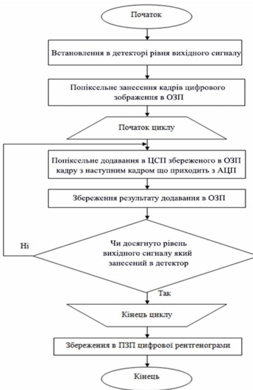
Рис. 3. Алгоритм цифрової обробки рентгенотелевізійного зображення
