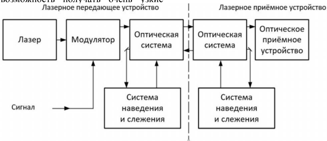
Рис. 1. Функциональная схема лазерной системы связи [1]
