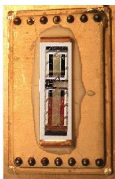
Рис. 2. Теоретична (а) і експериментальна АЧХ (б) та зразок (в) ПАХ-фільтра
