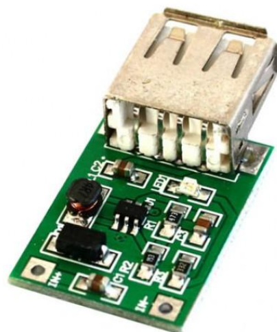
Рис.4 DC-DC конвертер, повышающий 0.9...5В в 5В с USB-разъемом.
