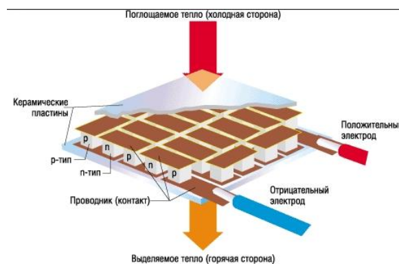
Рис.1 Устройство элемента Пельтье.
