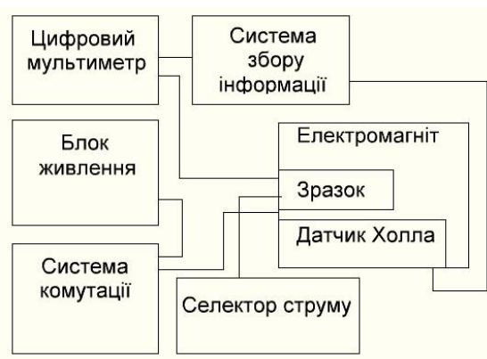
Рис. 1 Блок-схема електронної системи для вимірювання магнітоопору плівкових матеріалів з фіксованим вимірювальним струмом.
