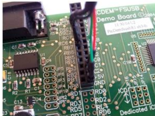
Рис.3. Зображення підключення оптичної миші до контактів мікроконтролера
