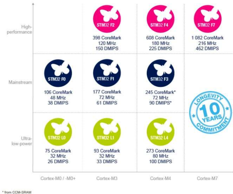
Рис.2.6. Сімейство 32-бітних мікроконтроллерів STM32
