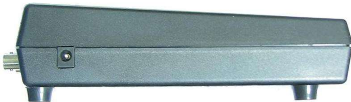
Рис.4.3. Вхідний роз'єм для підключення зовнішнього блоку живлення
