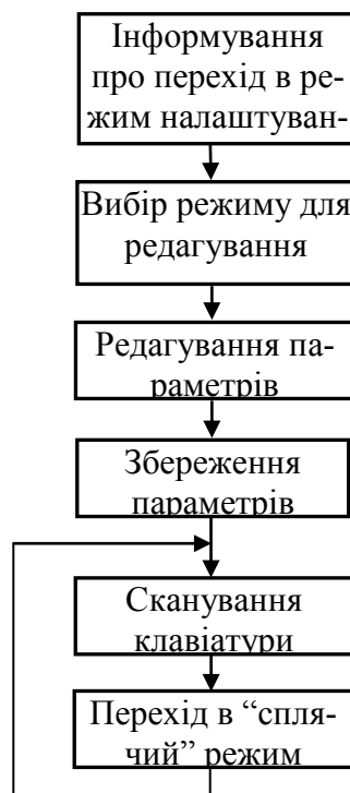
Рис.2.2. Алгоритму роботи блоку управління відеопроцесора в режимі налаштування
