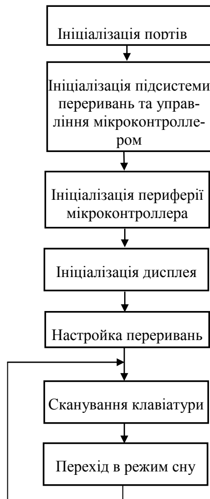
Рис.2.1. Загальний алгоритм функціонування блоку управління пристрою
