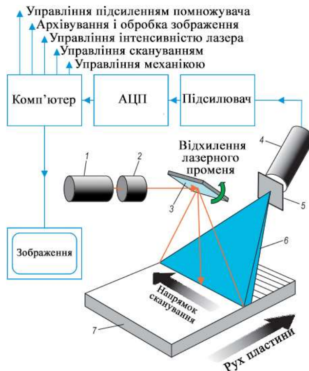
Рис.1.15. Схема процесу сканування запам'ятовуючої пластини і отримання цифрового зображення: 1 – лазер; 2 – оптика формування пучка; 3 – зеркало; 4 – фотопомножувач; 5 – фільтр; 6 – оптика збору світла люмінесценції; 7 – запам'ятовуюча пластина.
